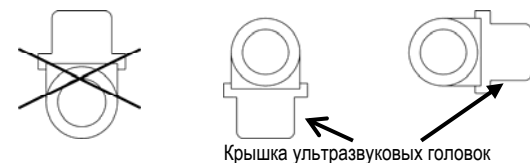
Рис. 6: Положение при встраивании для учета энергии охлаждения / холода
